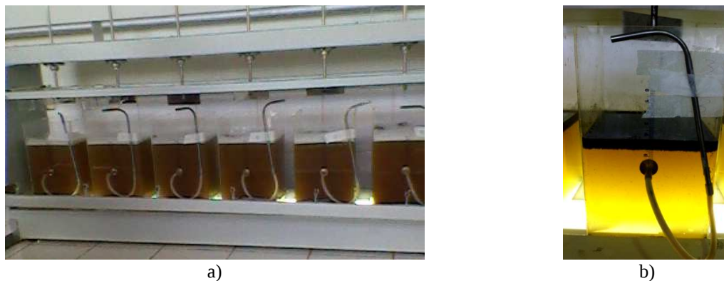
Figura 1: a) Foto Ilustrativa de “jar test” durante a etapa de acidificação, b) após acidificação.
